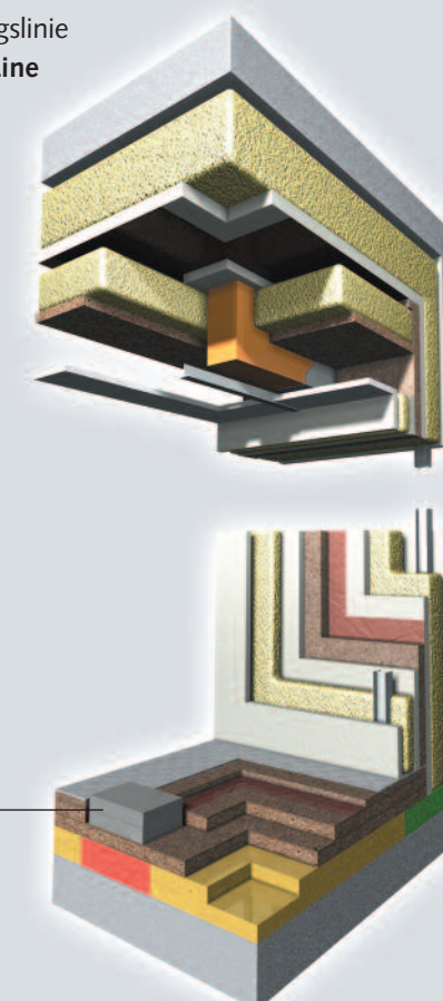
Magnetfußlager im Systemboden integriert auf speziellen Dämpfungselementen
